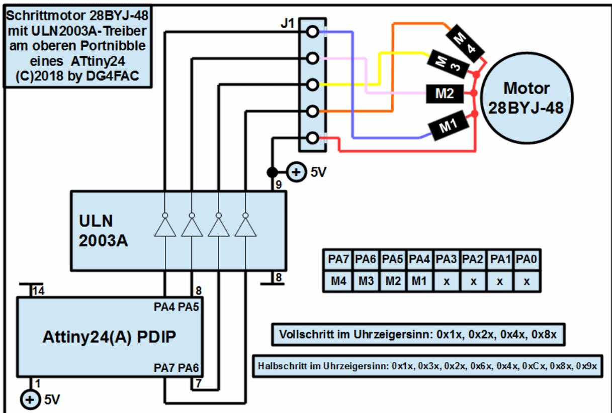
Aus dem Treiber- und dem Anschlussschema des ATtiny24 ergeben sich für die Bewegung des Motors im Uhrzeigersinn die dargestellten Hexadezimalwerte, mit denen der obere Port des ATtiny24 angesteuert werden muss.
