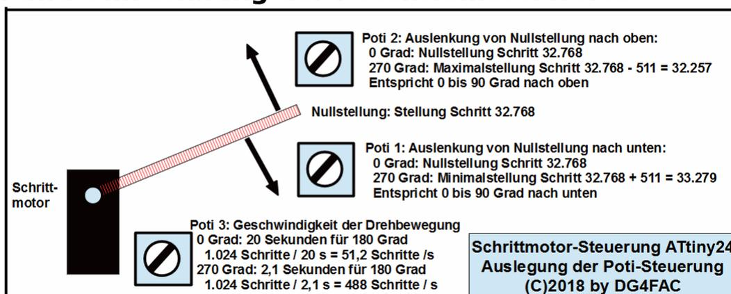
Mitte nach unten bzw. oben. Potentiometer 3 bestimmt, mit welcher Geschwindigkeit diese Bewegung des Schrittmotors erfolgt.
