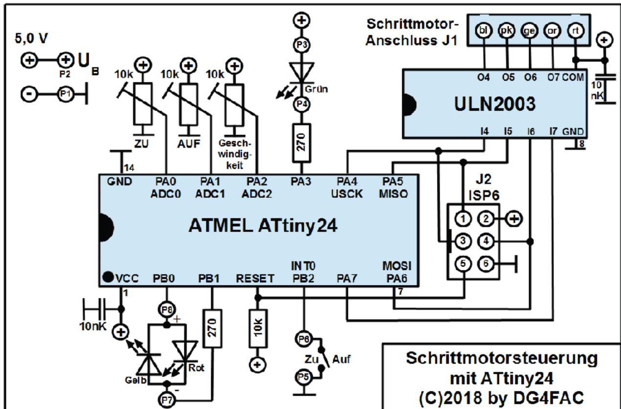
An den AD-Wandler-Eingängen ADC0 und ADC1 sind die Positionstrimmer angeschlossen. Der Schrittmotor folgt deren Einstellung beim Schliessen (ADC0) bzw. beim Öffnen (ADC1).
